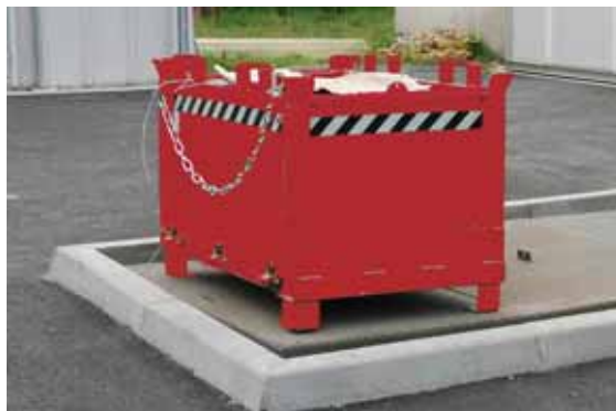
Exemple de petit conteneur récupérateur de déchets industriels spéciaux (DIS)
